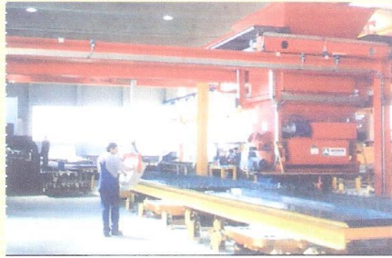
۱۰. دستگاه بتن ریز لایه ای بصورت کاملاً اتوماتیک
