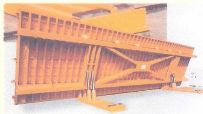
۱۶. نمایشی از شیب دادن به سطح میز که روی آن دیوار سافته شده، تا ۸۰ درجه دوران دارد
