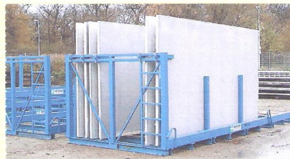
۱۷. شاسی مخصوص جهت حمل دیوارهای دوجداره و تک جداره که توسط جرثقیل دروازه ای بار تریلی می شود.
