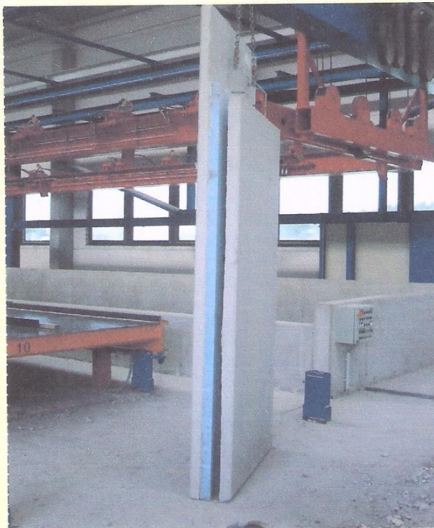
۳۹. نمونه ای از دیوار دوجداره عایق دار
