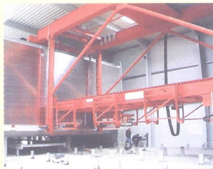
۱۲. ممان بفر و بالابر مخصوص بلند کردن میز و قرار دادن آن در یکی از قفسه های ممان بفر
