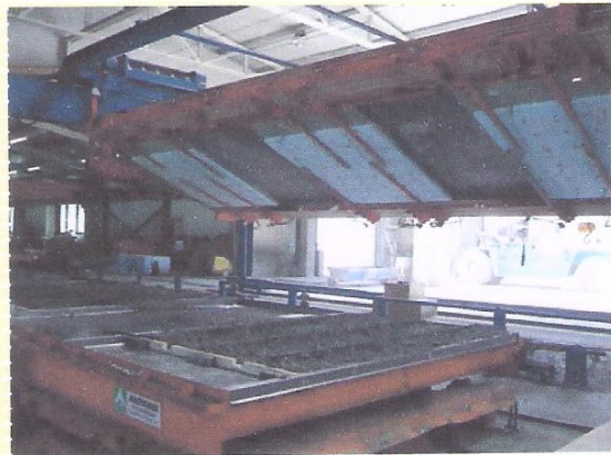
۳۷. روش دوجداره کردن دیوار عایق دار
