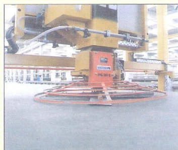
۱۹. ماله برقی دوار جهت صیقلی دادن سطح دیوار
