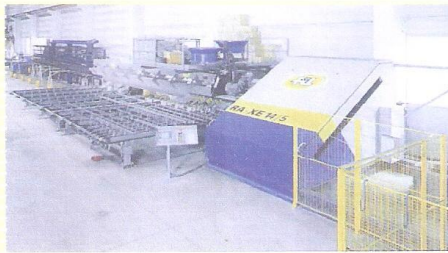
۷. دستگاه جهت صاف کردن آرماتور کلاف و برش آرماتور طبق جدول میلگردها
