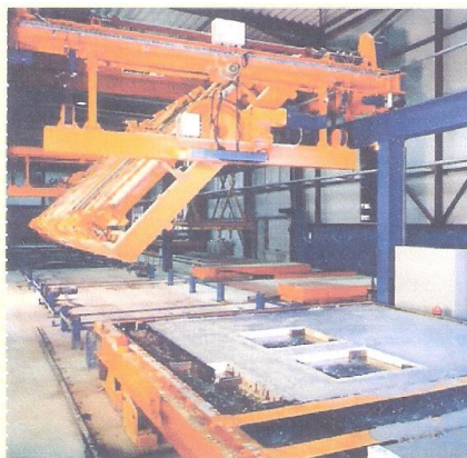
۱۵.نمایی از چرخاندن میز و وجه اولیه دیوار و قراردادن آن داخل وجه دومی
